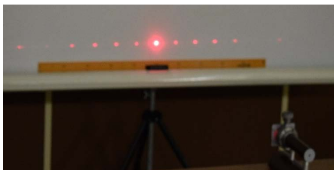
Рис. 3. Вид дифракционной картины на экране, полученной при использовании дифракционной решетки
