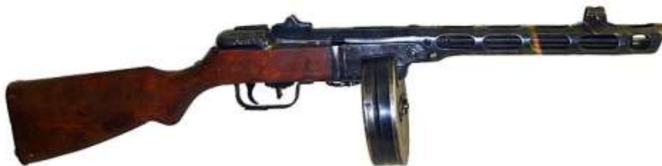
Рис. 2. ППШ-41 (пистолет - пулемёт Шпагина, СССР) с круглым магазином
